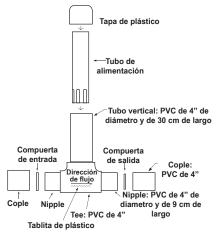
El tubo de alimentación contiene las pastillas de cloro, hecho de tubo PVC 3" diámetro y 13" largo, diseñado con ranuras, permitiendo el contacto del agua con las pastillas. El tubo de alimentación es sostenido en la parte baja por un platillo de plástico, fijado con cemento PVC y tornillos de acero inoxidable o espiches.
