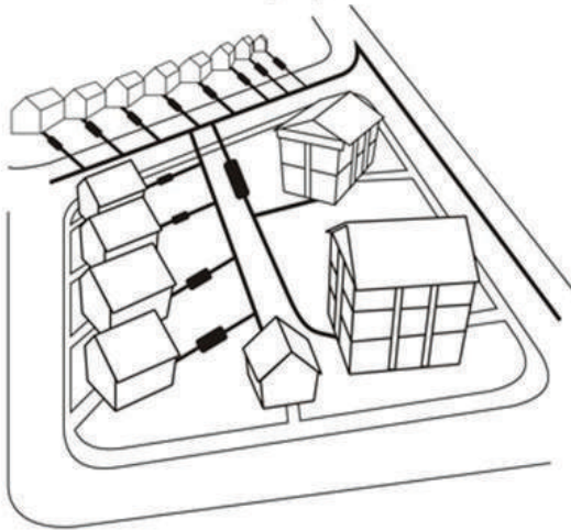
Alcantarillado de pequeño diámetro
